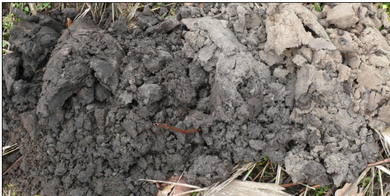
Figuur 4: boorkern met de gereduceerde C-horizont
