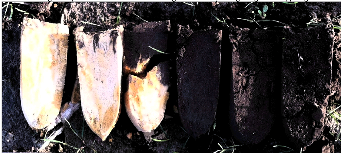
Figuur 4: Boring 004 van een zogenaamd AC-profiel
