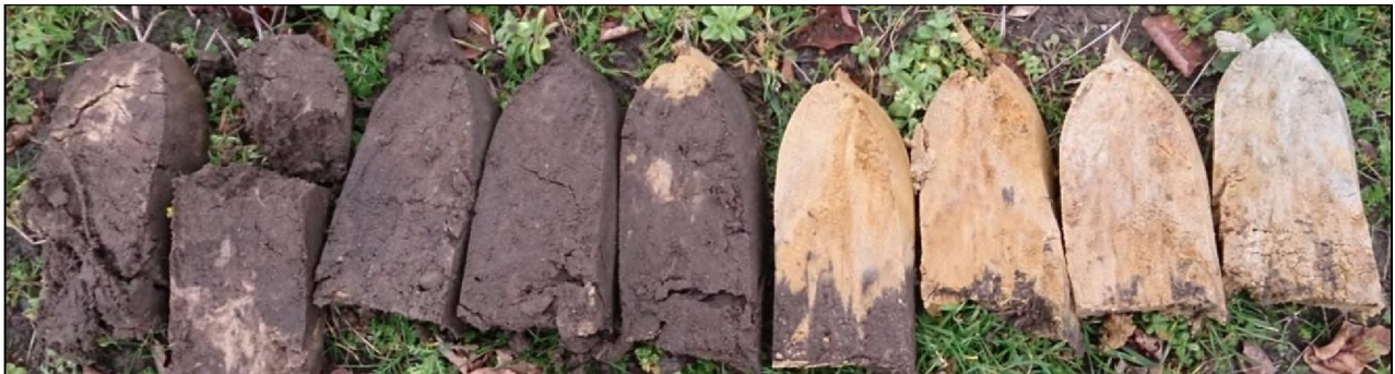
Figuur 6: de boorkern van boring 5 met de scherpe overgang tussen de boven- en ondergrond.
