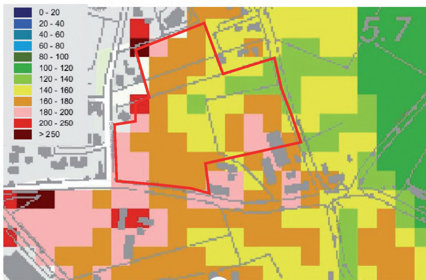
afb. 2.4 boven; Gemiddeld Hoogste Grondwaterstand onder; Gemiddeld Laagste Grondwaterstand
