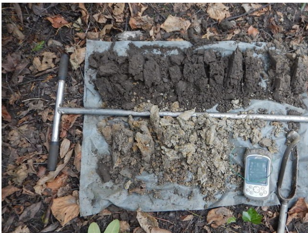
Figuur 19: Foto van boorprofiel 3. De grond is uitgelegd van links naar rechts, en van boven naar onder.
