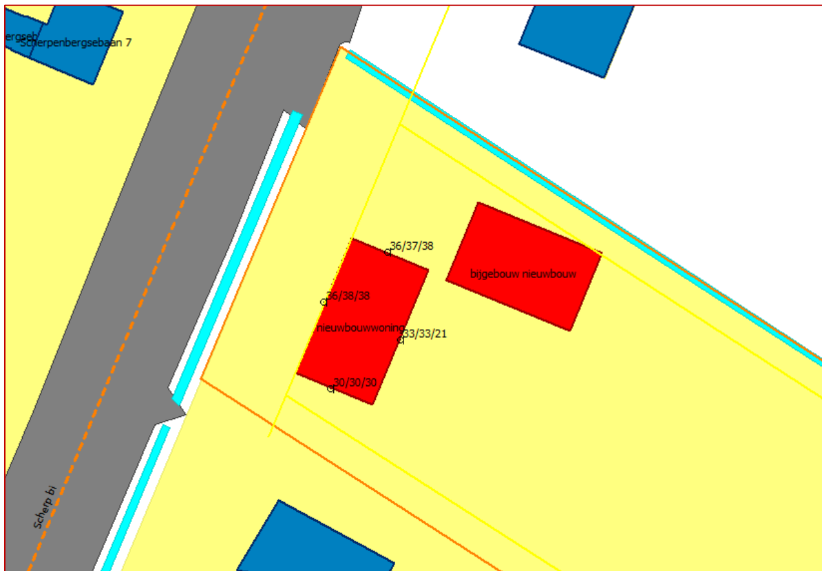
Figuur 4.1: Rekenresultaten vanwege de Scherpenbergsebaan, inclusief 5 dB aftrek.
