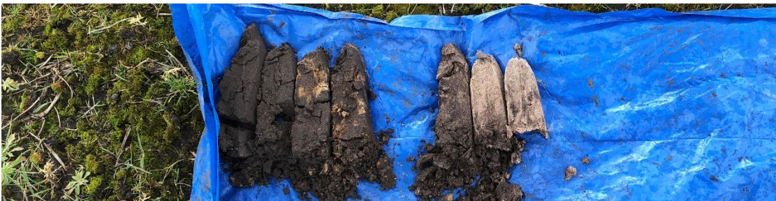
Boring 3: 0-80 cm -Mv. Dieper gelegen zand loopt uit de boor door het grondwater.
