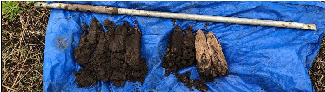
Boring 1: 0-100 cm -Mv. Dieper gelegen zand loopt uit de boor door het grondwater.
