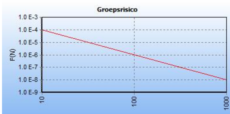
5.5 Figuur 5.5 FN curve voor 5215_leiding-Z-529-27-deel-1 van N.V. Nederlandse Gasunie voor de kilometer tussen stationing 0.00 en stationing 1000.00
