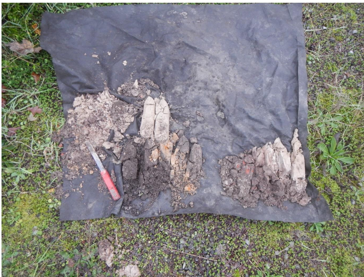
Boring 1 (uitgelegd van links naar rechts, onder naar boven).
