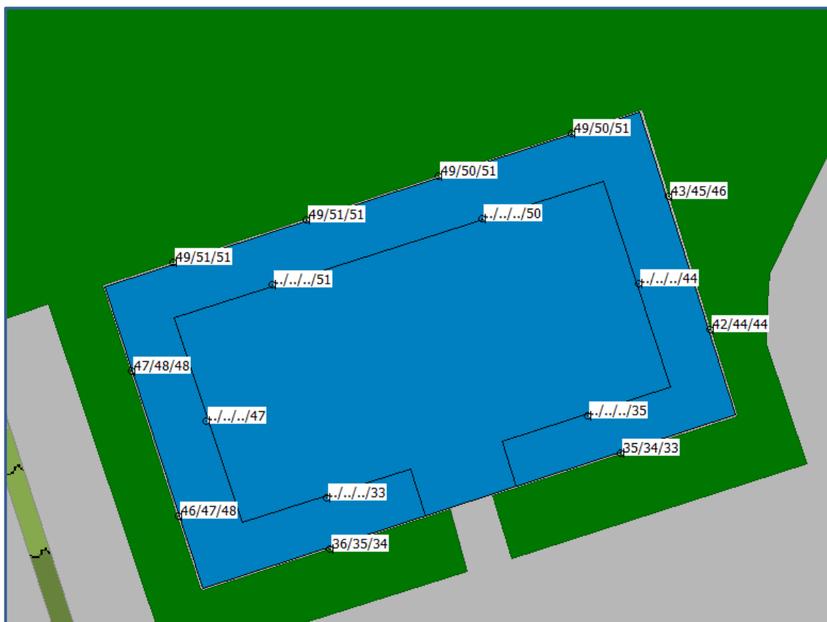
Afbeelding 6. Geluid L_{den} Gemeentewegen Berekend geluid op een hoogte van 2,0 ; 5,0 t/m 11,0 meter
