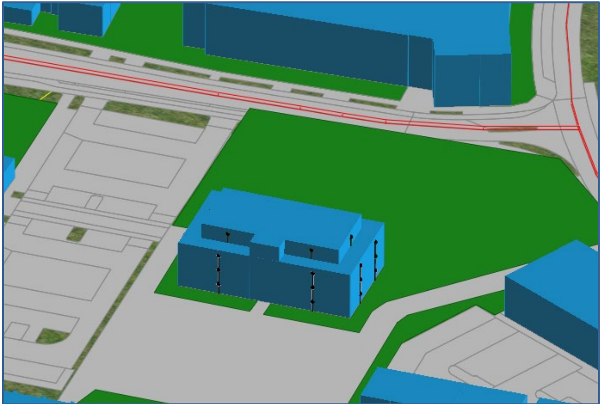
Afbeelding 5. Rekenmodel wegverkeerslawai, 3d-weergave
