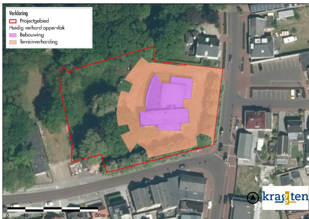
Figuur 9 Huidig verhard oppervlak
