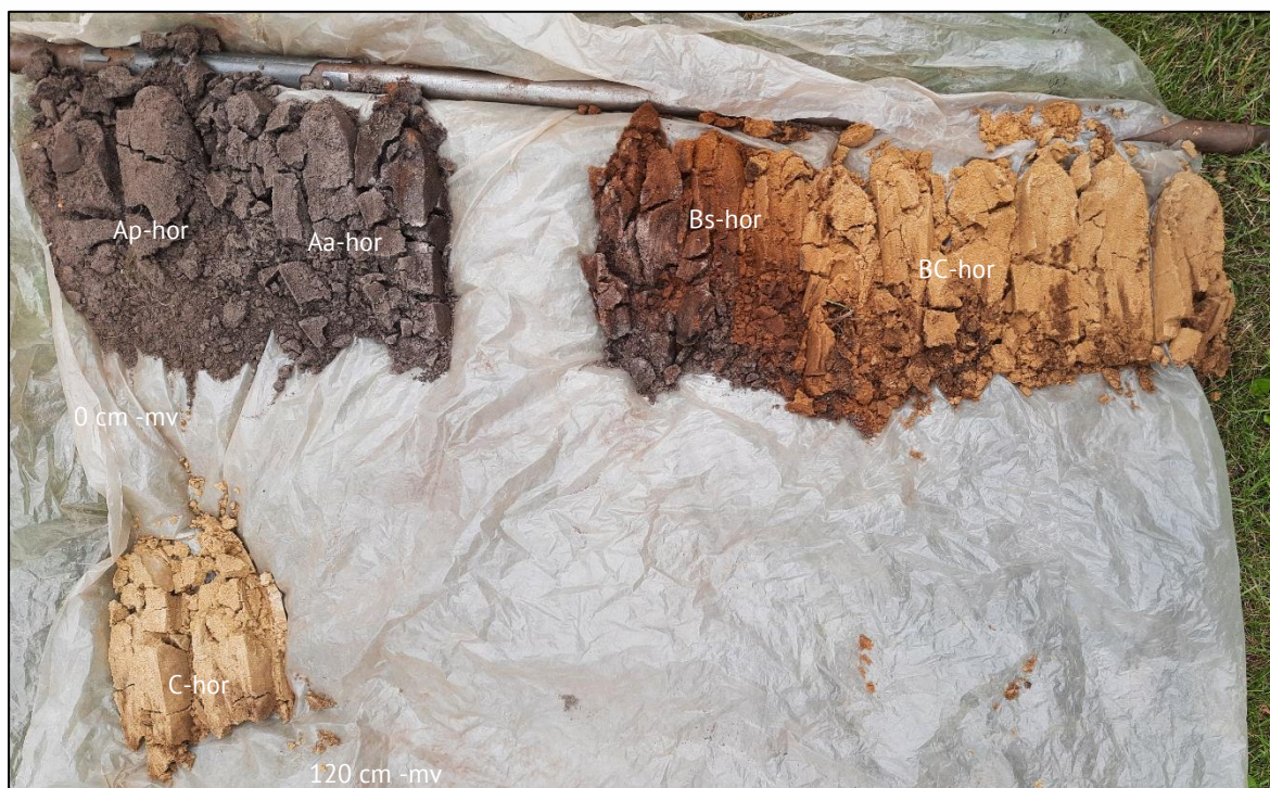
Figuur 9. Foto van boring 5. De leesrichting is van linksboven naar rechtsonder (0 – 120 centimeter): matig humeuze, donker bruin-grijze A-horizont, een Bs-horizont die scherp overgaat naar de oranjebeige BC-horizont die geleidelijk overgaat in een licht geelbeige kleur (C-horizont) (Foto: 21 juni 2022).
