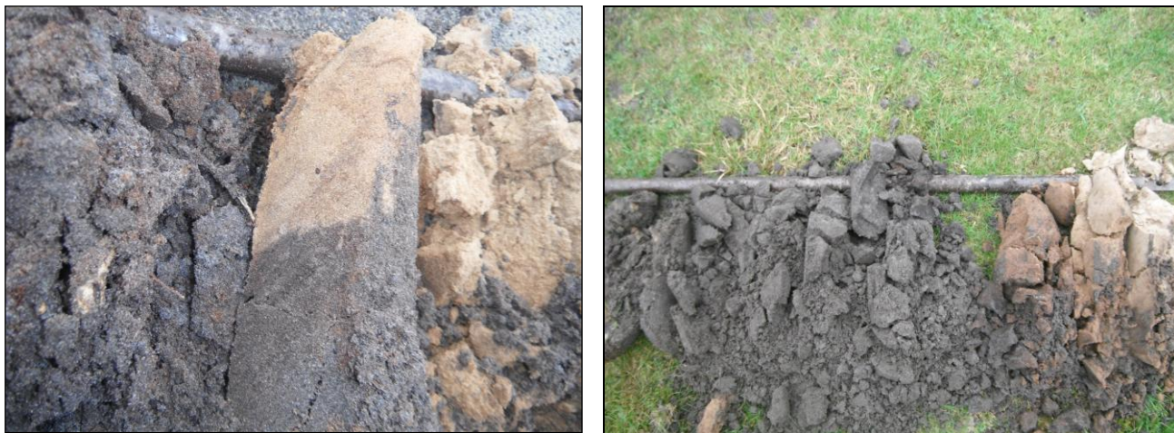
Figuur 5: scherpe overgang (A-C profiel) van boring 4 (links) en een geleidelijke overgang in boring 6 (rechts)
