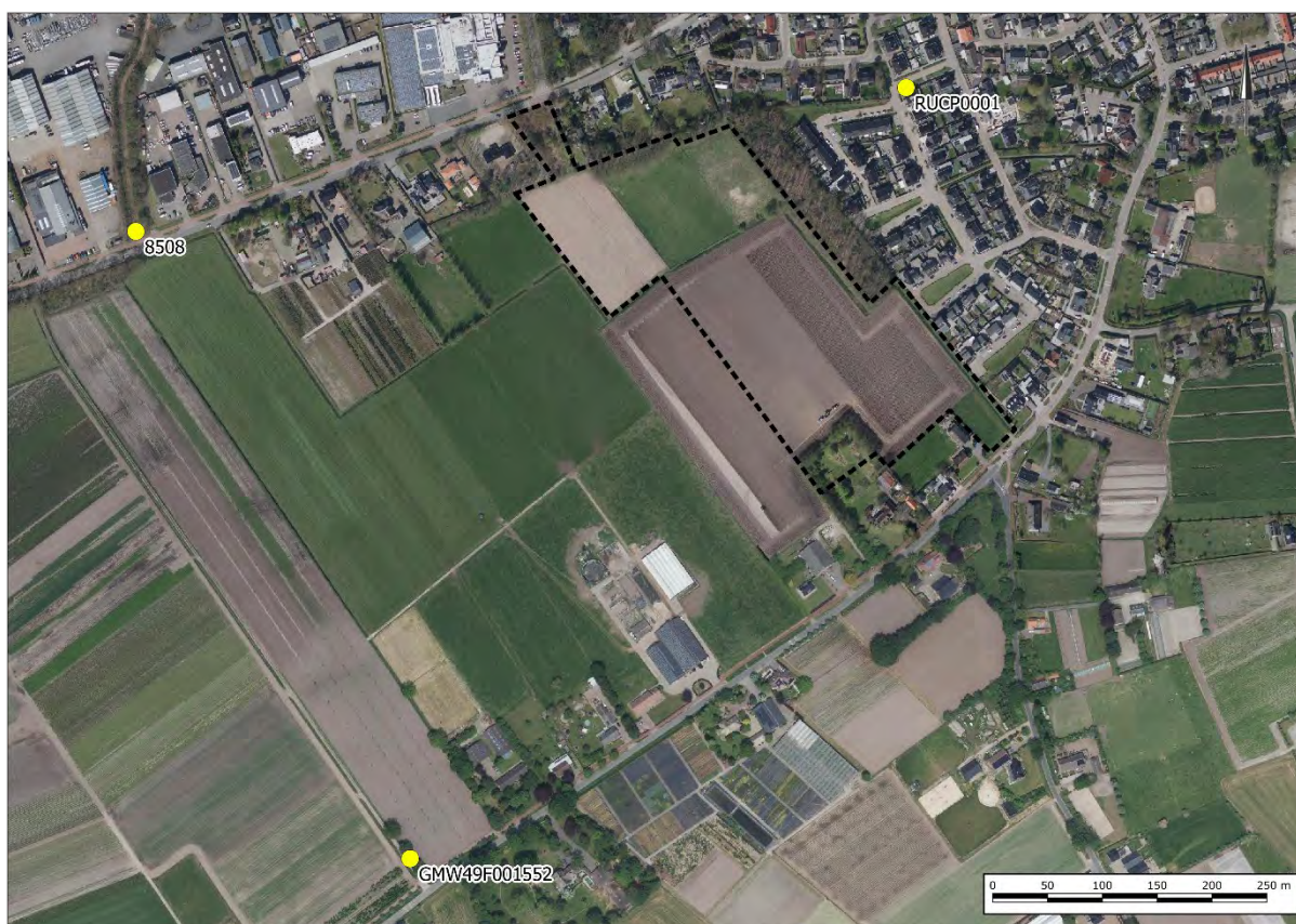
Figuur 3.2 Situering gebruikte grondwaterpeilputten
