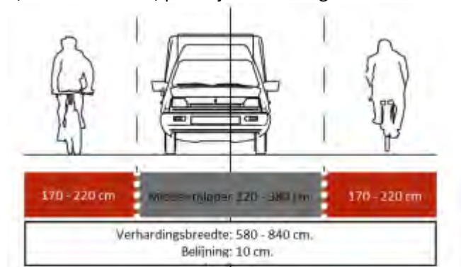
Figuur 5 Wegprofiel GOW30 met smalle rijloper voor verkeer in 2 richtingen. Bron: Handreiking voorlopige inrichtingskenmerken GOW30, CROW mei 2023
