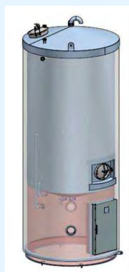
figuur 2: silo met geluidsarme omkasting van de elektrische motor voor roerwerk en pomp
