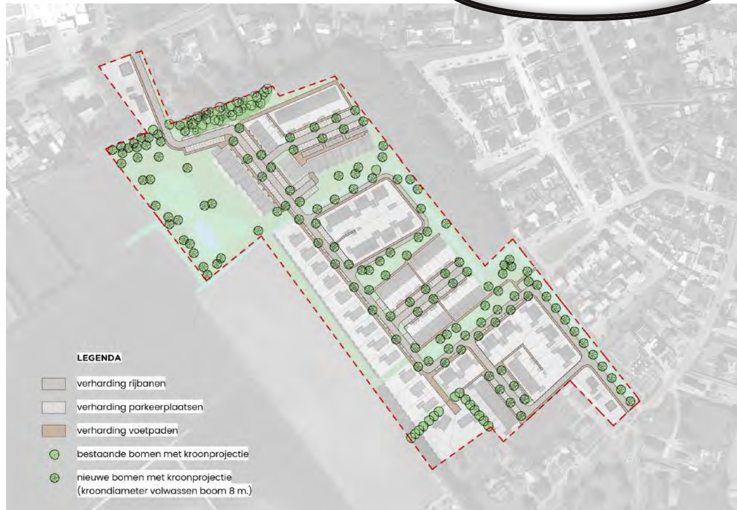
kroonprojectie boven verharding voorkomt hittestress
