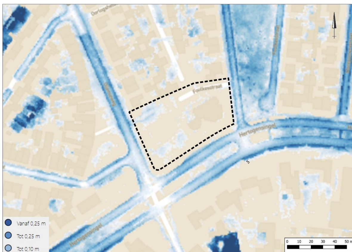
Figuur 4.2 Stresstest, bui 60 mm in 1 uur (bron: AS50 watersamenwerking).
