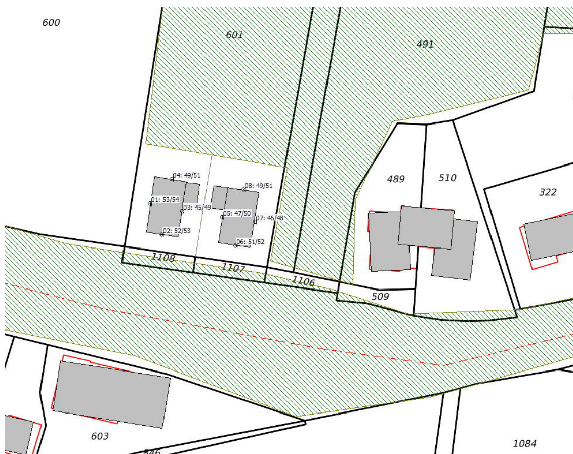
Figuur 2: Geluidbelasting ten gevolge van wegverkeerslawaai incl. aftrek volgens art. 110g Wgh, ten gevolge van A50. Bij rekenpunt 01 is in de afbeelding sprake van een aftrek van 2 dB, conform artikel 3.4 Wgh is deze aftrek 3 dB.
