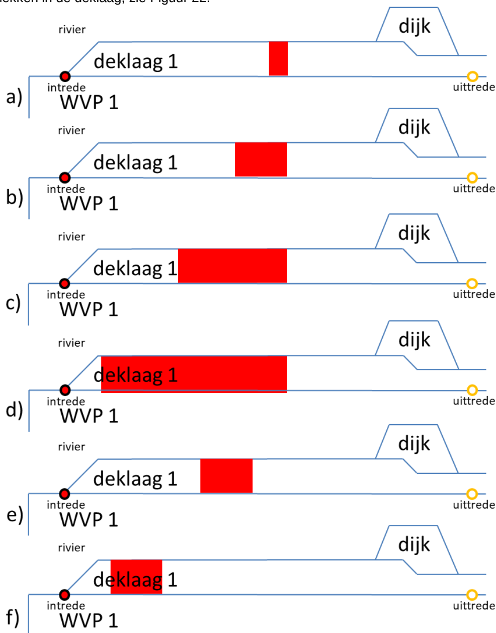
Figuur 22: Schets van simulaties van zwakte in de deklaag. a) zone van 10 m breed, b) zone van 50 m breed c) zone van 100 m breed, d) zone van 280 m breed. Daarna is de afstand tot de kruin/kwellengte vergroot voor het scenario in b). In d) bedraagt de afstand 100 m tot de kruin. In e) bedraagt de afstand 160 meter tot de kruin. De kruin is hier als maat genomen omdat deze na dijkversterkingen waarschijnlijk ongeveer op dezelfde plek ligt.
