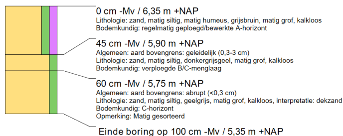
Figuur 25: Resultaten van boringen 63, 64 en 65 (Pepers 2014).
