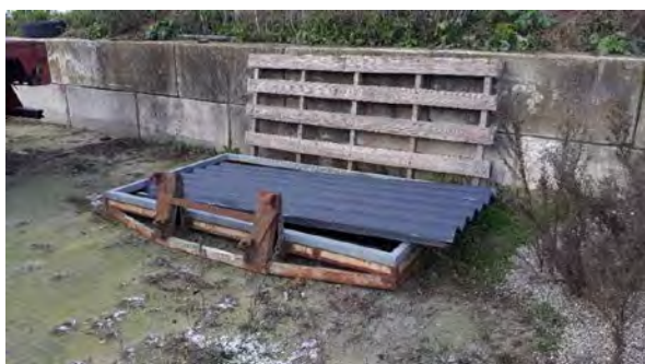
Terrein, golfplaten met NT-opdruk, niet asbestverdacht (NT = Nieuwe Techniek)
