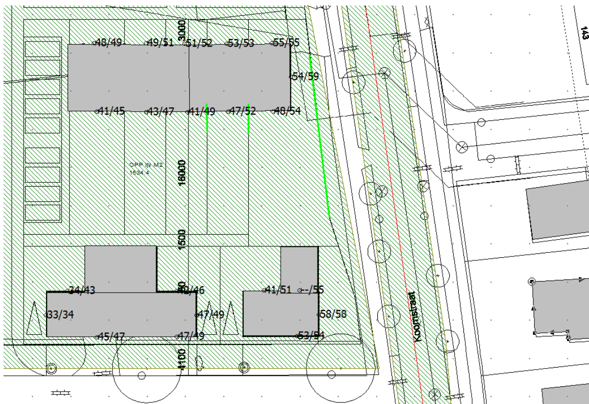
Figuur 4: Geluidbelasting ten gevolge van de Koomstraat, geluidluwe gevels d.m.v. schermen van 2 meter hoog.
