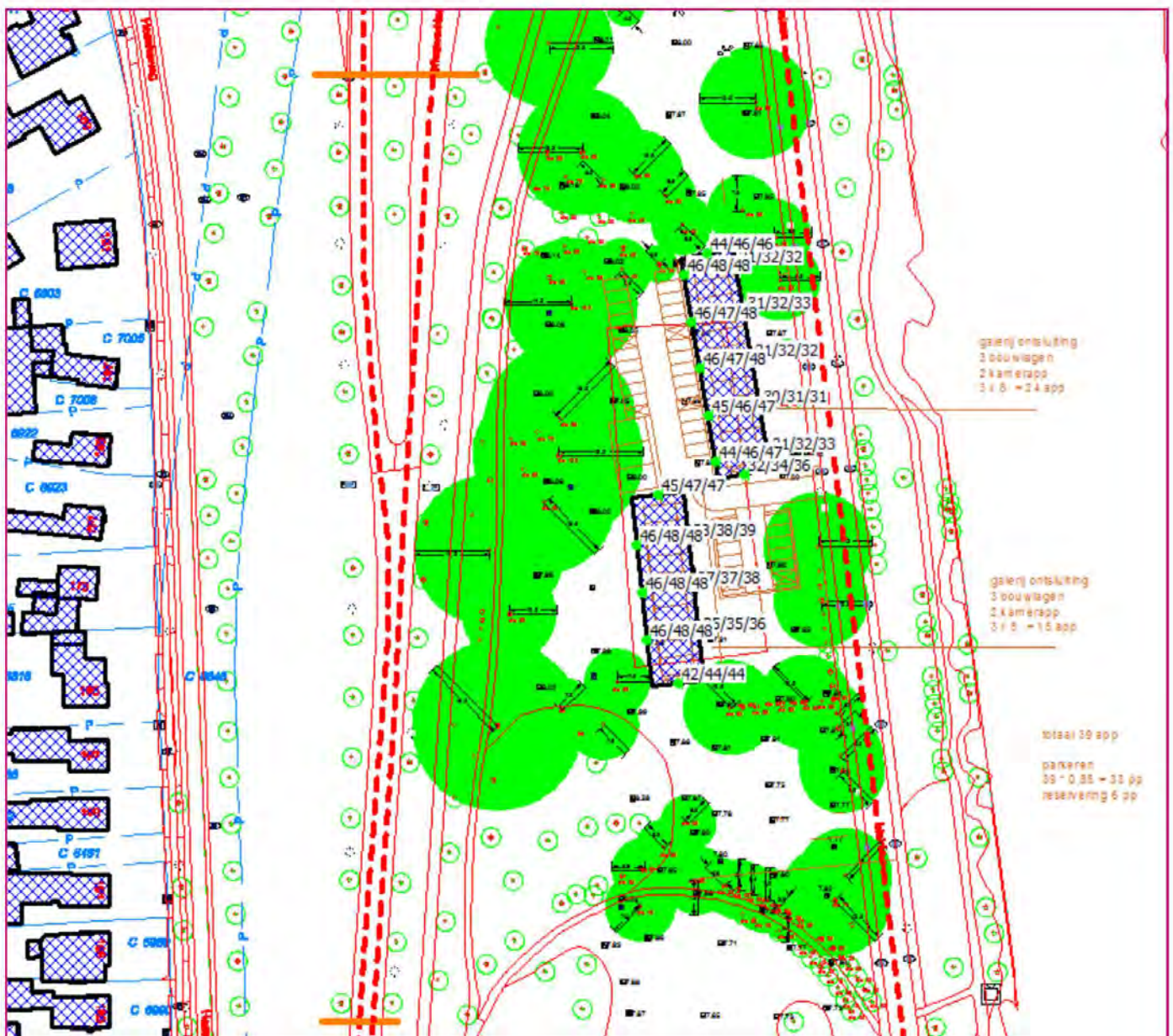
Figuur 5.2 Uitsnede resultaten L_{den} in dB vanwege Nieuwe Hescheweg met geluidreducerend asfalt ddB
