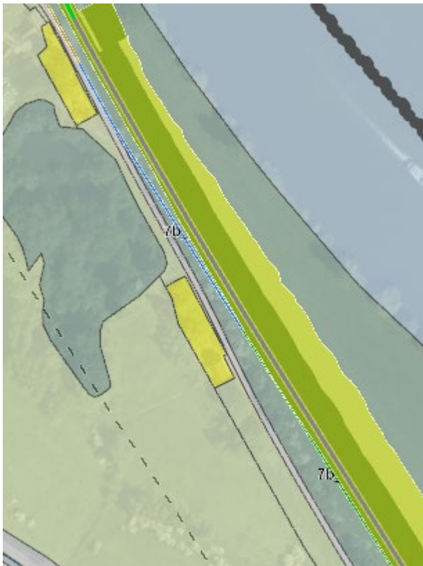
Afbeelding 1.14 Dijkzone 7B_1 en 7B_2: verharde weg valt buiten verkeersbestemming en is in de huidige situatie niet aanwezig
