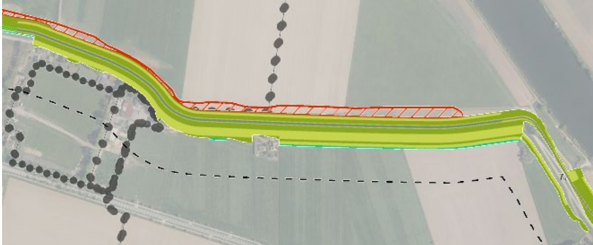
Afbeelding 1.13 Dijkzone 7A_2 verharde weg is breder dan huidige verharde weg en valt buiten verkeersbestemming
