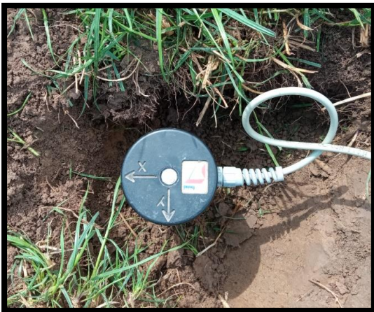
Figuur 4: Foto van de geofoon op meetpositie 2.
