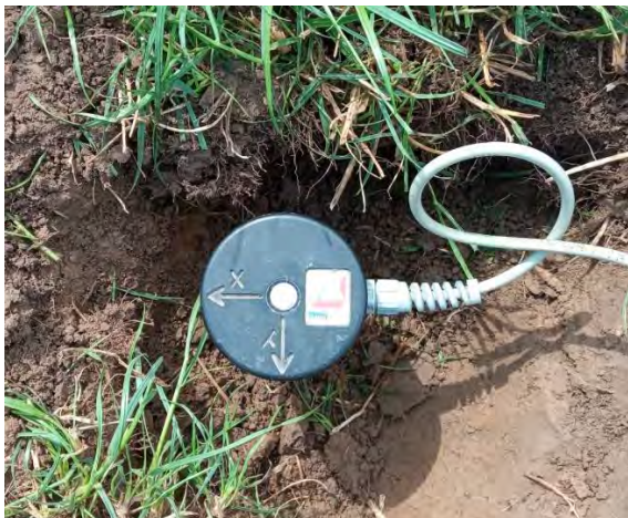
Figuur 4: Foto van de geofoon op meetpositie 2.
