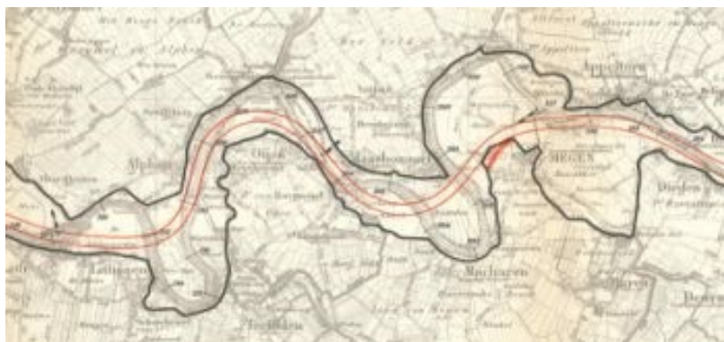
Afbeelding 2.1 Verbetering van de Maas voor grote afvoeren , C.W. Lely, 1926
