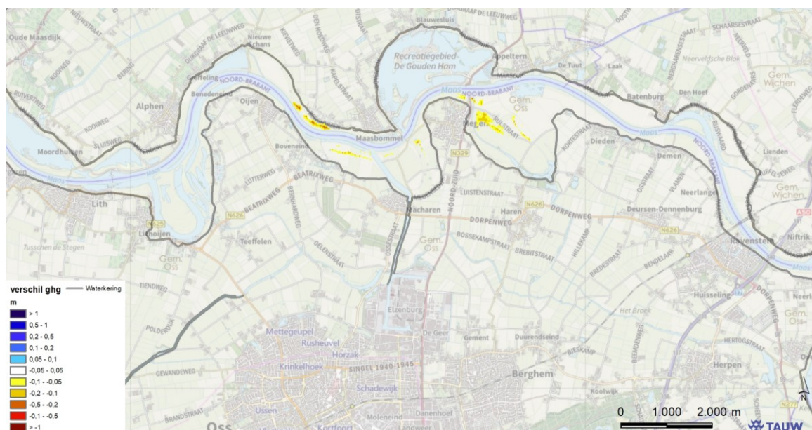
Afbeelding 4.5 Berekende verschil in GHG (m) als gevolg van rivierverruimende en dijkversterkende maatregelen
