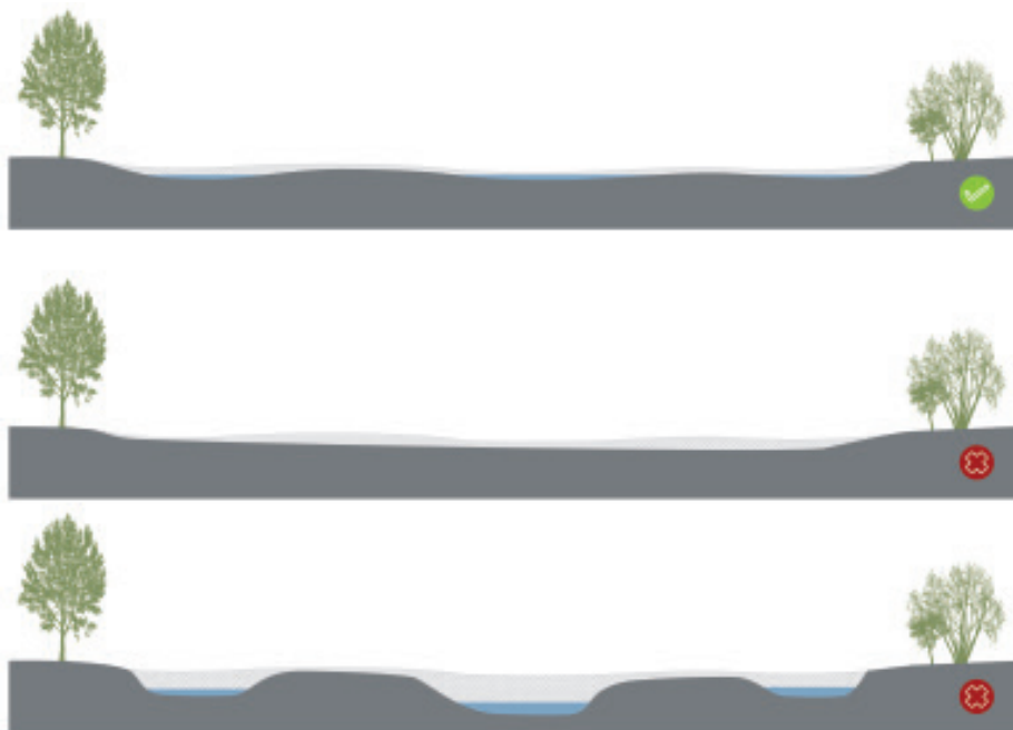
Reliëfvolgend ontgraven, met behoud of versterking van de geomorfologie, plasdras en verwijderen bouwvoor; opzoeken van de zandige lagen.
