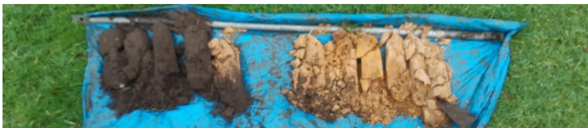
Afbeelding 11 De boorkernen van boring 4631009. Bron: foto Vestigia d.d. 27 januari 2021.
