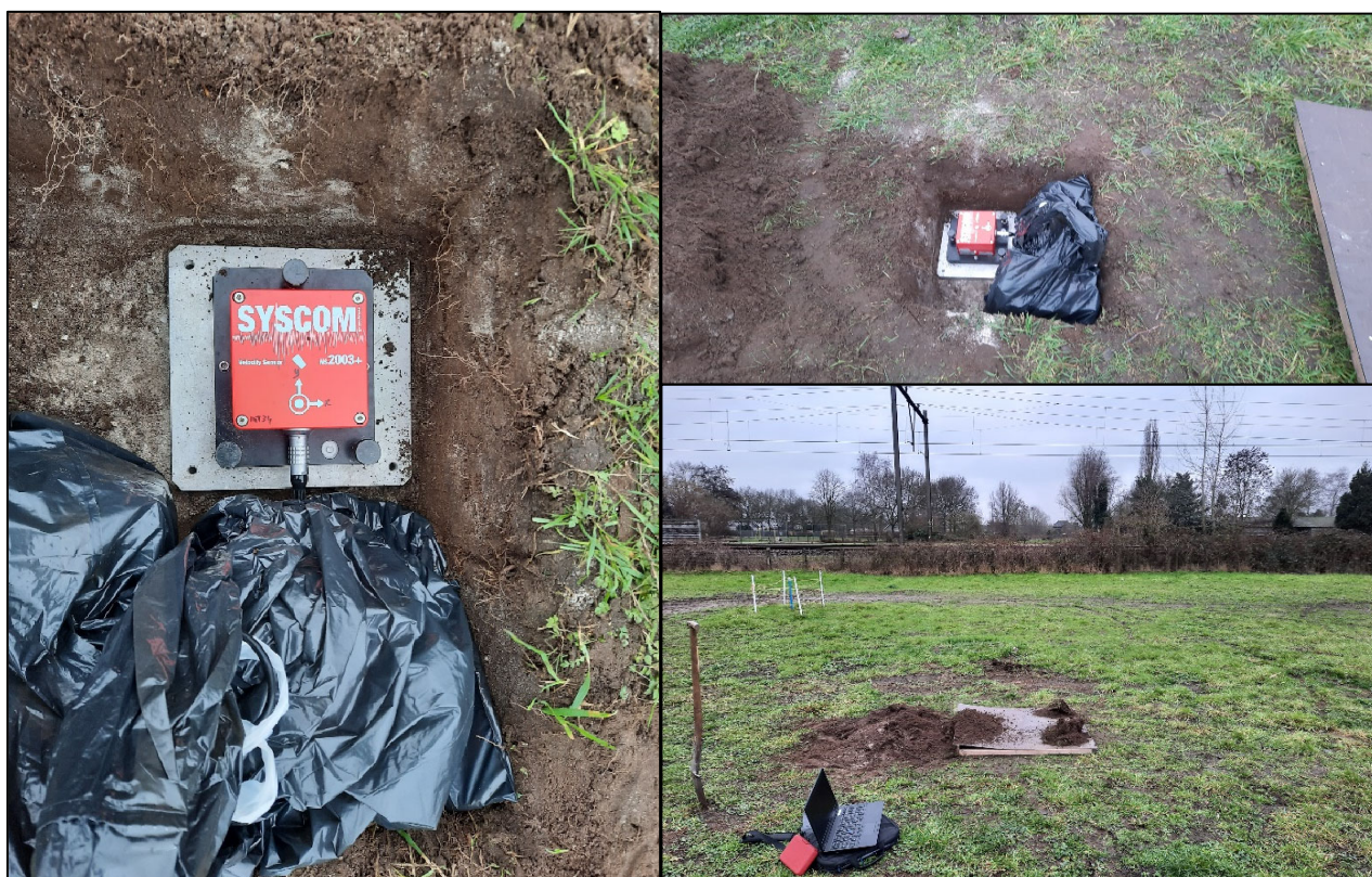
Figuur 3.2: De trillingssensor geplaatst bij meetpunt A_2 tijdens de eerste periodes en hoe deze is afgedekt
