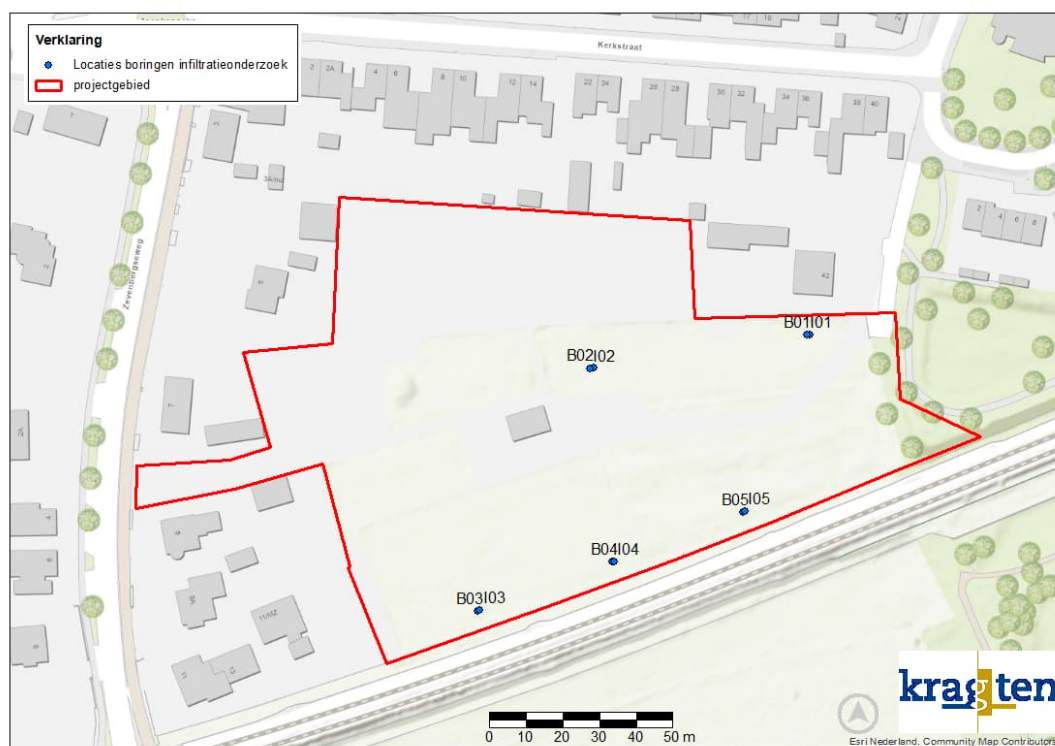
Figuur 7 locaties boringen en infiltratiemetingen
