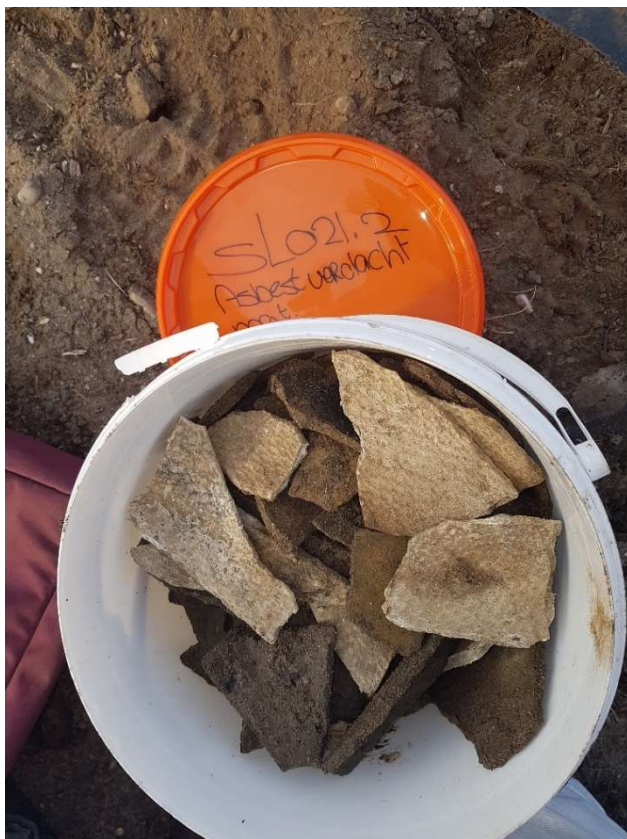
Omschrijving: Asbestverdacht materiaal sleuf SL021
