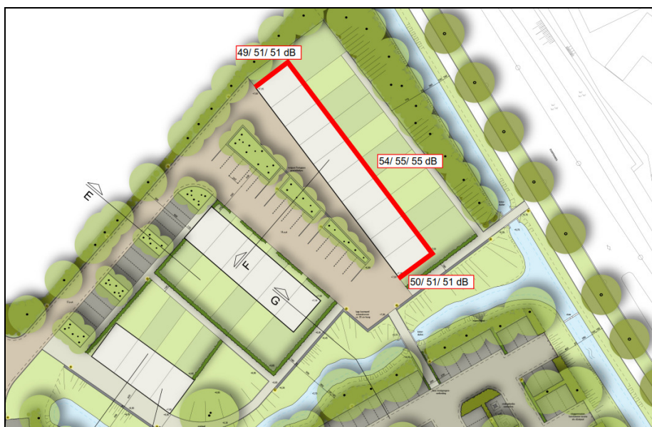
Figuur 4.2: Overzicht overschrijdingen t.g.v. wegverkeer op de Dorpenweg t.p.v. grondgebonden woningen
