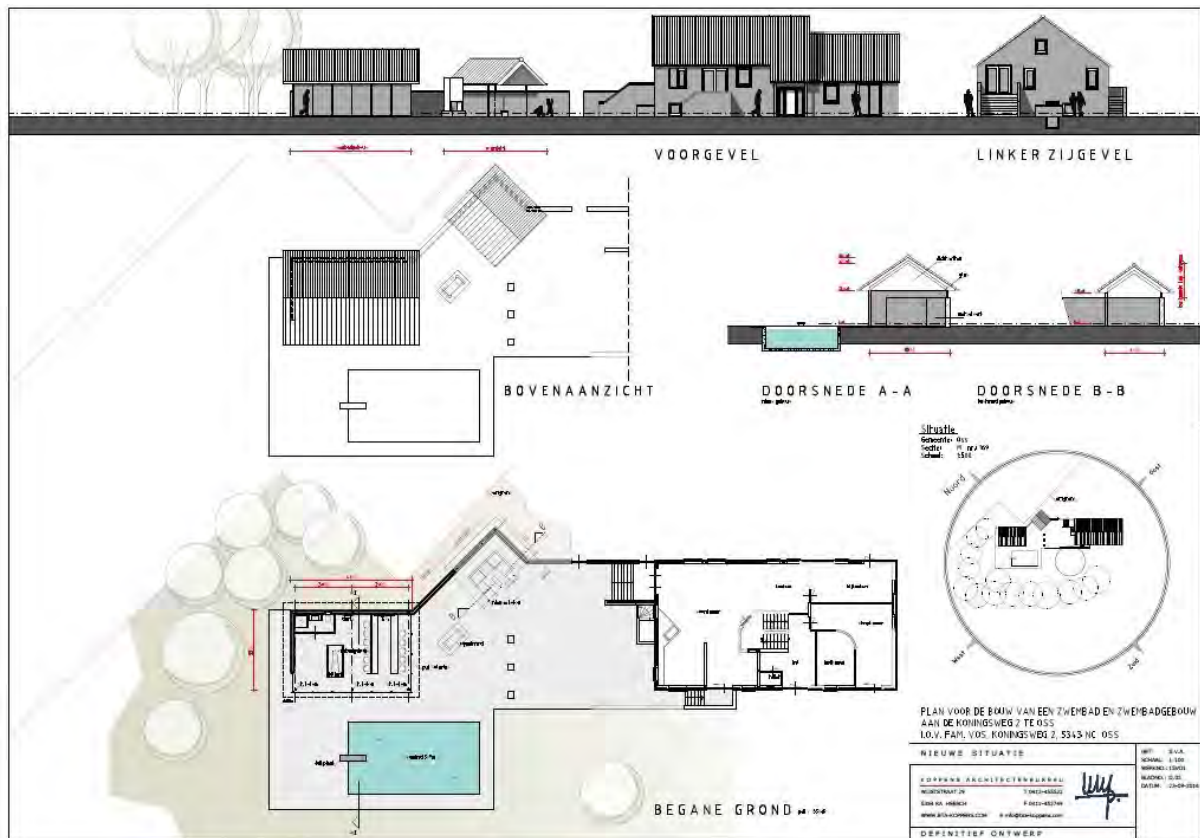
Afbeelding: Nieuwe situatie plattegrond en gevelaanzicht
