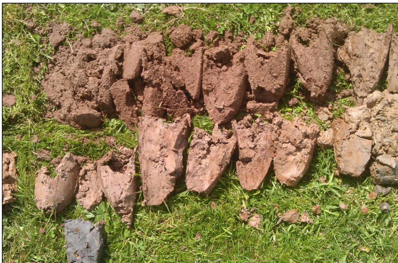
Figuur 8: boorprofiel van boring 10, met enkel kleidek 1 op het onderliggende grijze zand.
