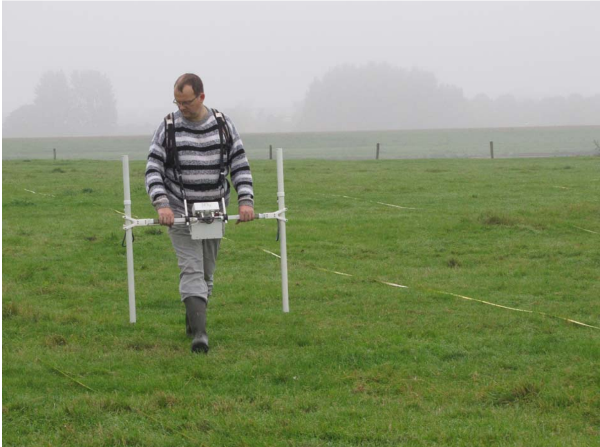
Figuur 10: Het verrichten van magnetometer metingen met de Bartington Grad601 magnetometer.
