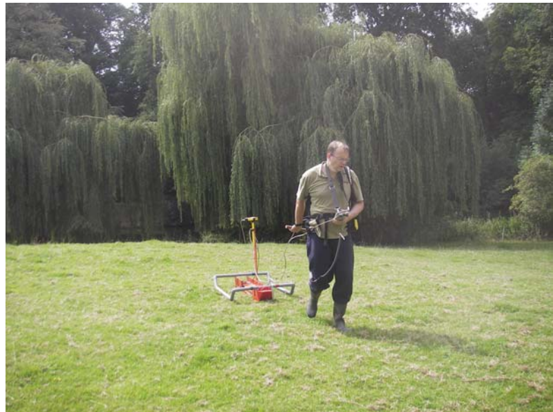
Figuur 11: Het verrichten van de EM-38-metingen. De spoelen zitten in de oranje slede.
