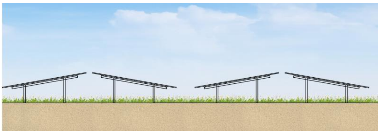
Figuur 4: zonnepanelen georiënteerd op het oosten en westen.
