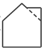
Dak met verhoogde gevel
