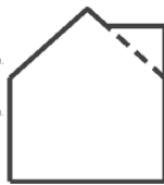
Dak met verhoogde gevel
