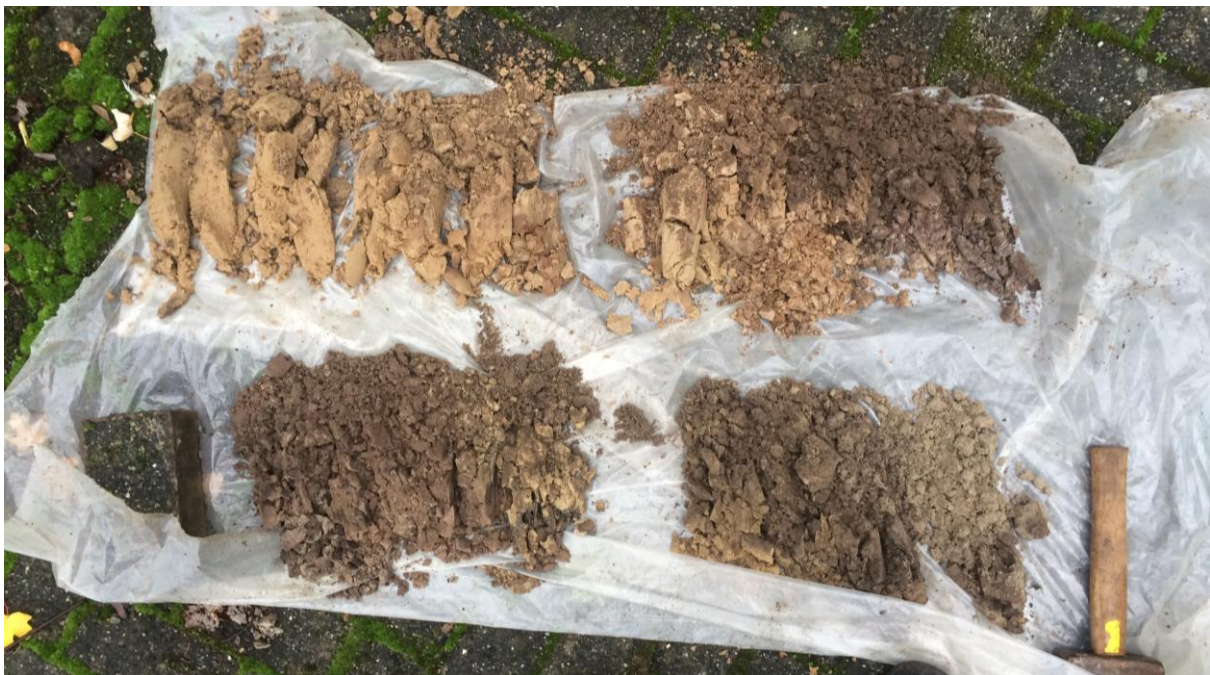
Opname van boring 7. Verstoord tot in het pleistocene zand.
