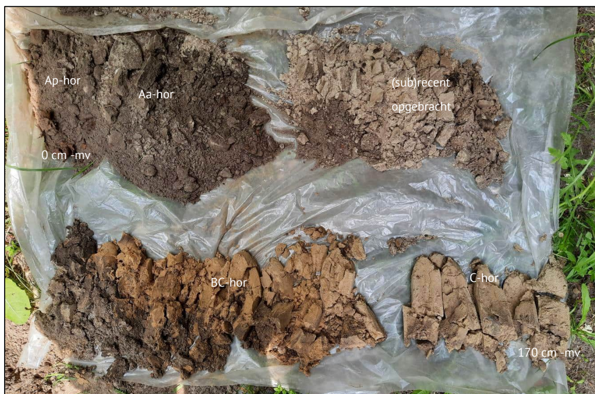
Figuur 7. Boorprofiel van boring 6. De leesrichting is van links naar rechts (0-170 centimeter onder maaiveld). (Foto: 16 juni 2021).
