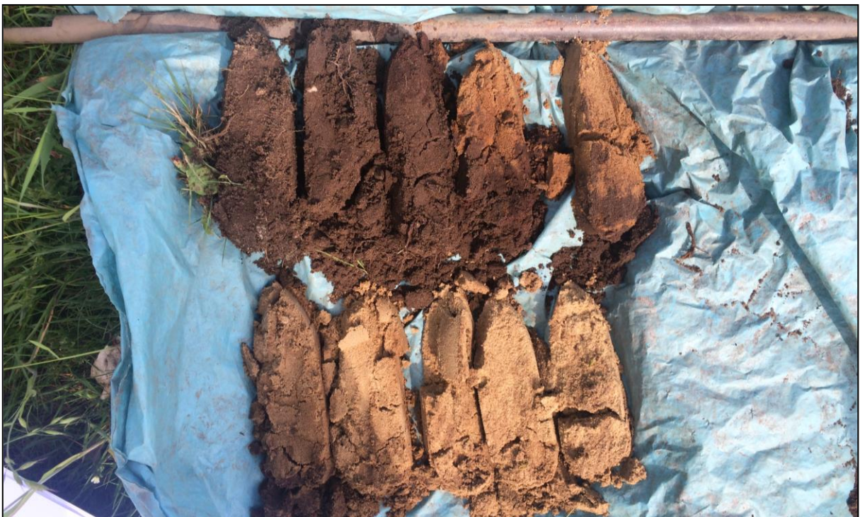
Boring 4: totaaloverzicht - boorkernen
