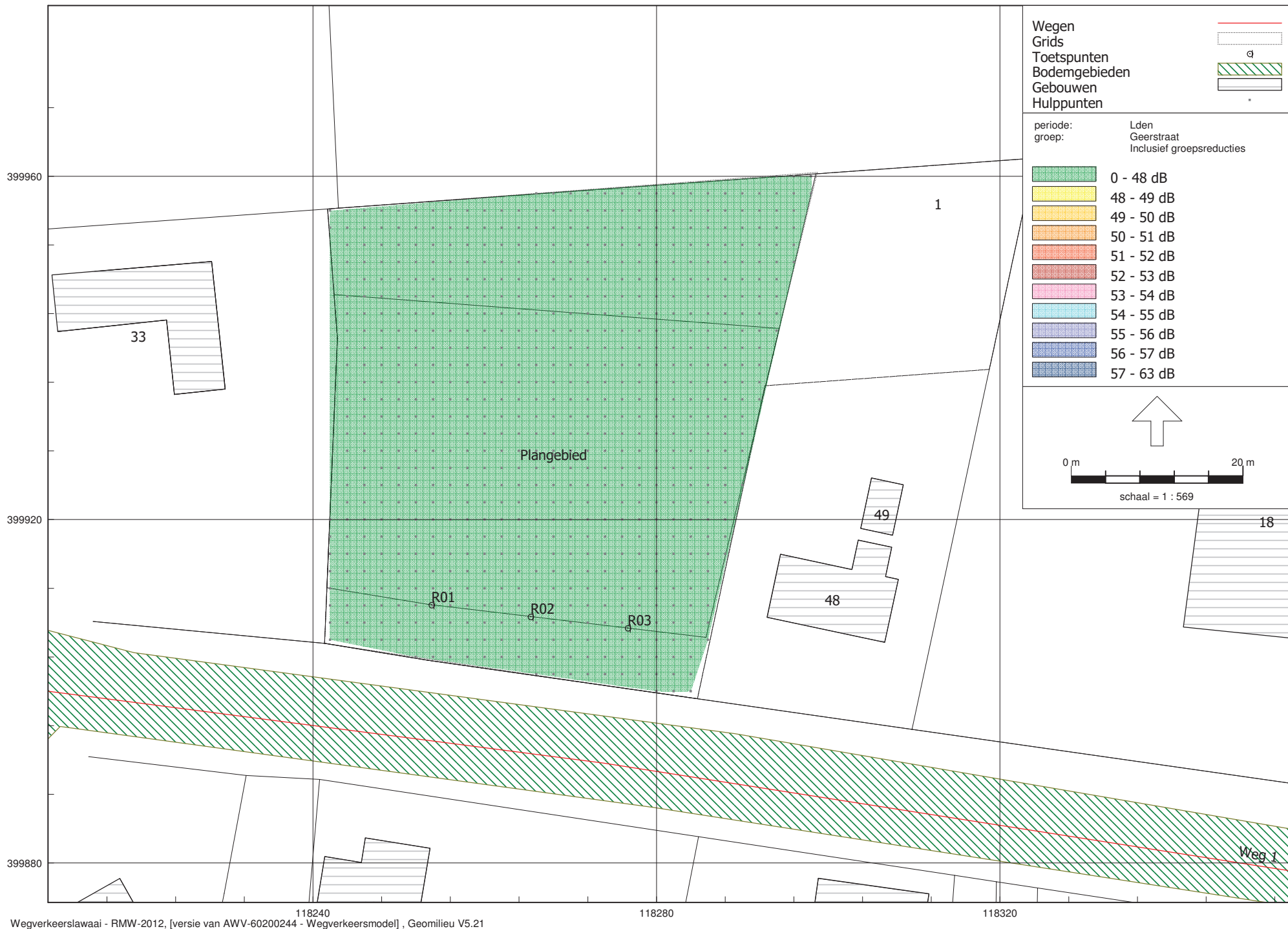
Figuur 5: Geluidcontourenkaart Geerstraat (grid 7,5m hoogte) [incl. aftrek 5 dB]
