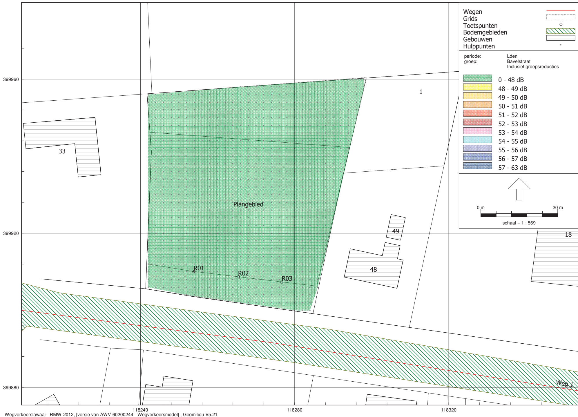
Figuur 4: Geluidcontourenkaart Bavelstraat (grid 1,5m hoogte) [incl. aftrek 5 dB]
