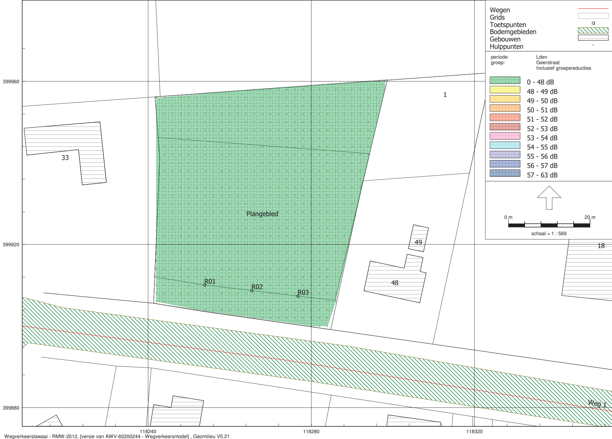
Figuur 5: Geluidcontourenkaart Geerstraat (grid 1,5m hoogte) [incl. aftrek 5 dB]
