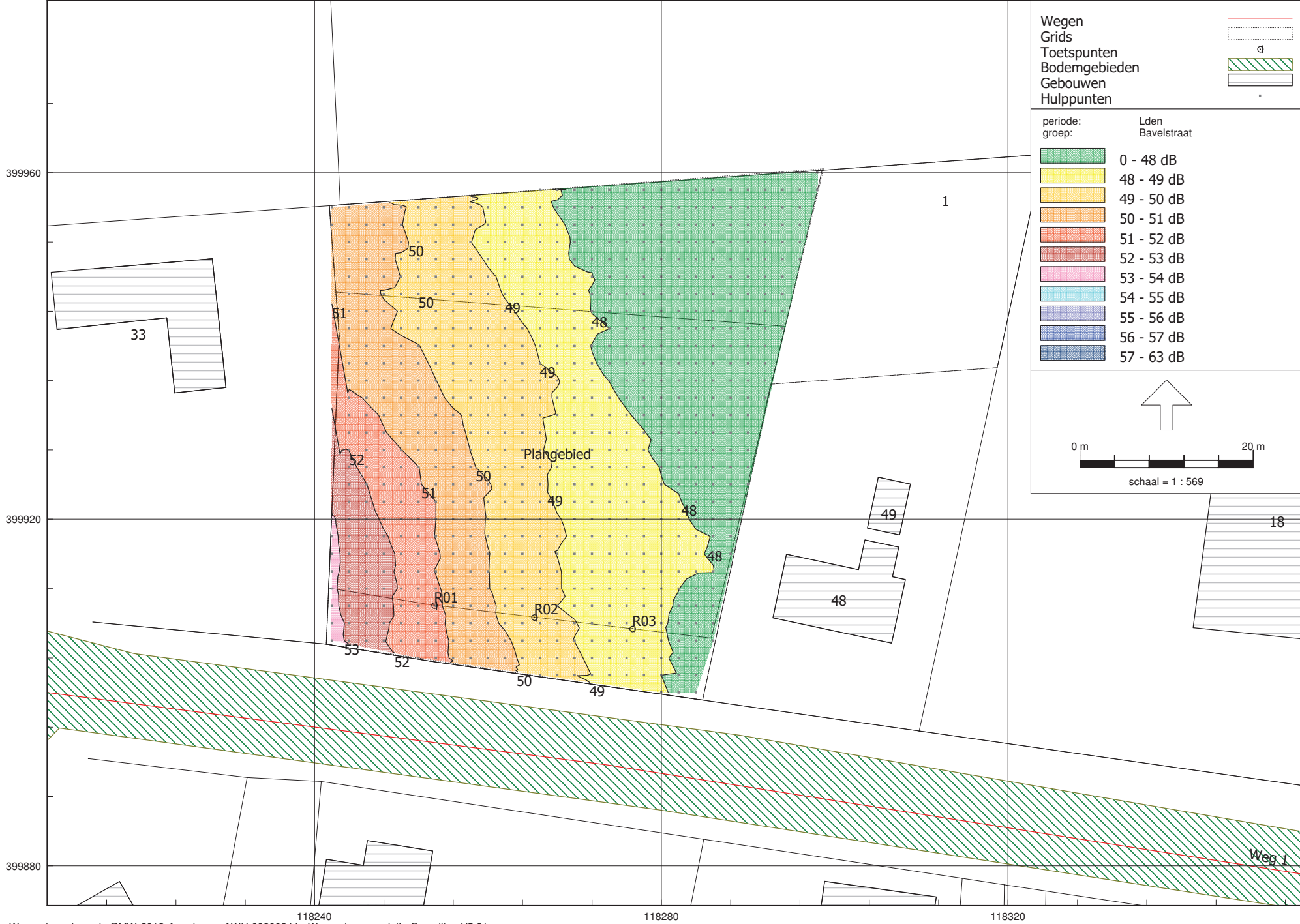
Figuur 4: Geluidcontourenkaart Bavelstraat (grid 7,5m hoogte) [excl. aftrek 5 dB]
