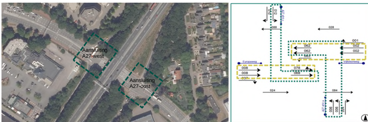
Afbeelding 2: huidige vormgeving (links) en gekoppelde richtingen (rechts) van VRI-kruispunt aansluiting A27
