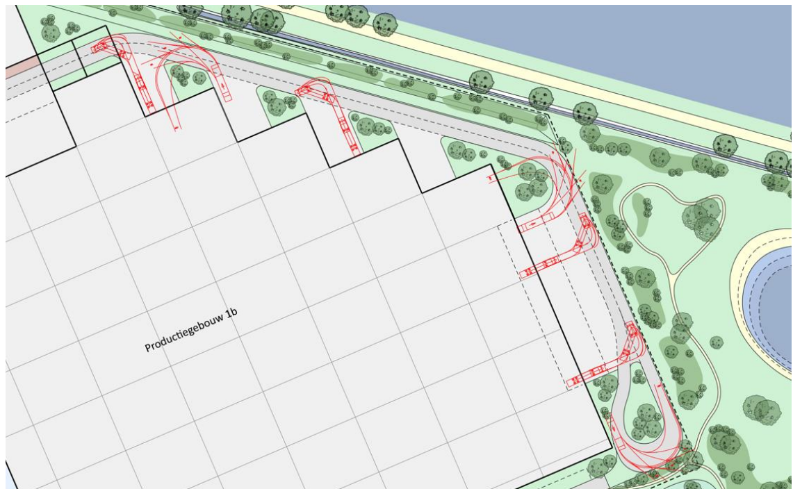
Figuur: Uitsnede met draaicirkels vrachtwagens, oostzijde
