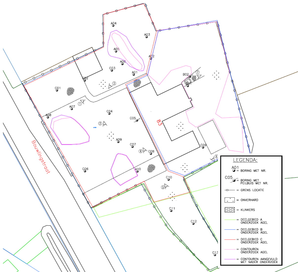
Figuur onderzoeksgebieden (situering boringen, peilbuizen en verontreinigingssituatie)
