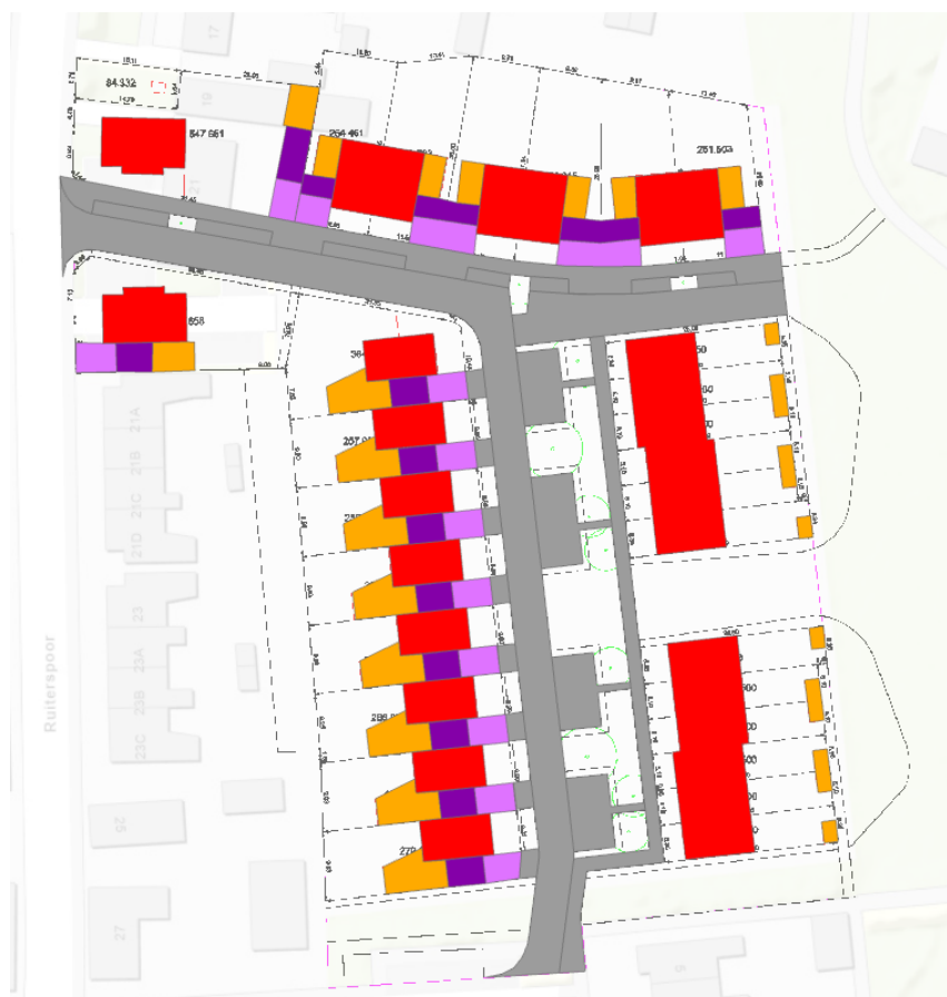
Figuur 6-3: afvoerend oppervlak
