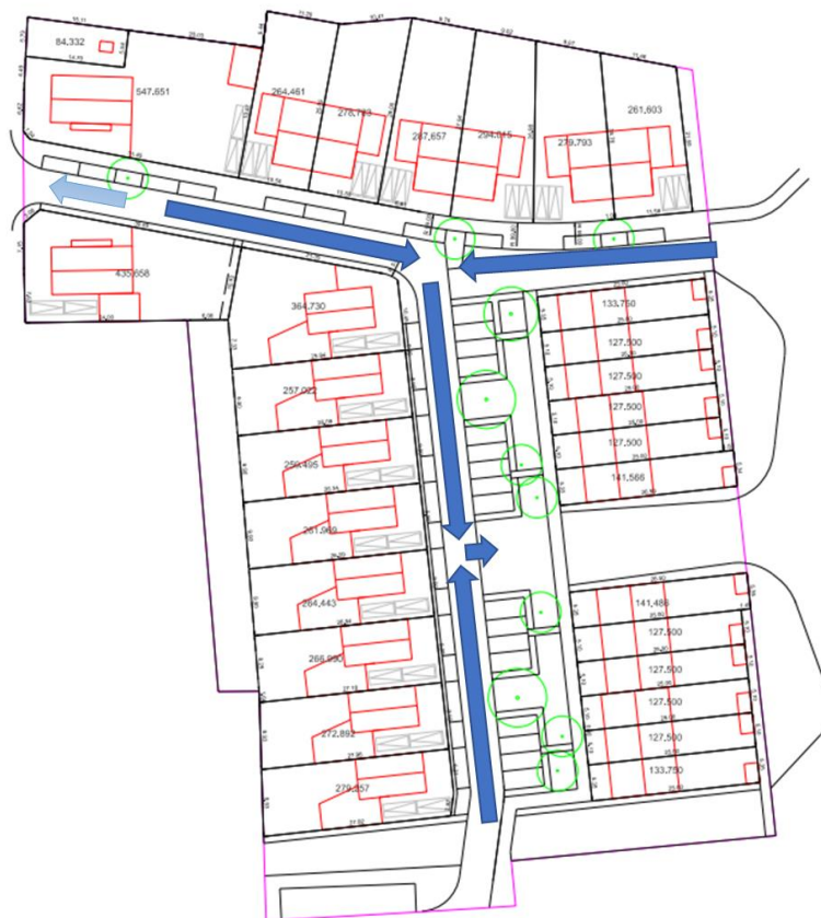
Figuur 6-4: afvoerstructuur hemelwater over rijbaan
