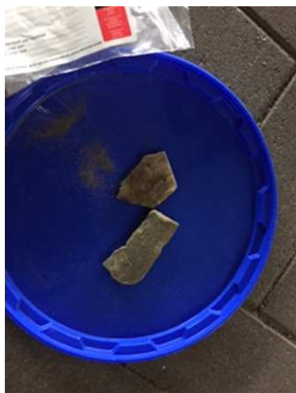
Foto 10: Stukken asbestverdacht materiaal proefgat 2-06
