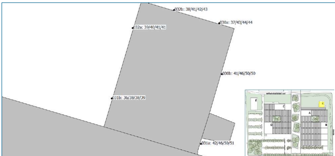
Figuur 3: Geluidbelasting blok K bedraagt ten hoogste 51 dB(A) met toepassing van geluiddempers of isolerend materiaal op het leidingwerk op het dak. Op Blok K is dit nog steeds hoger dan de grenswaarde van 50 dB(A). Echter kan gemotiveerd worden afgeweken naar 55 dB(A). Dan is hier wel sprake van een aanvaardbare geluidbelasting (in dit situatie zonder maatregelen is dit echter ook al het geval).
