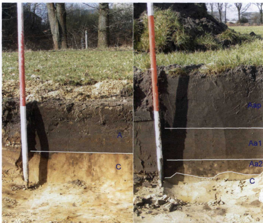
Afb. 6. Bodem in het plangebied. De linker foto is gemaakt van proefsleuf 2. De bodem bestaat uit een A/C-profiel met een zeer scherpe overgang. De rechter foto is gemaakt van proefsleuf 17. Onder de bouwvoor (Aap) bevindt zich een esdek (Aa1) met daaronder een restant van een oude akkerlaag Aa2).
